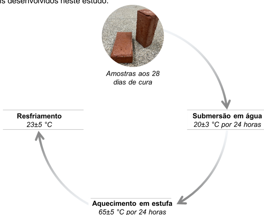
Figura 53 - Ciclo de saturação e secagem utilizado para avaliação da durabilidade dos materiais desenvolvidos neste estudo.
