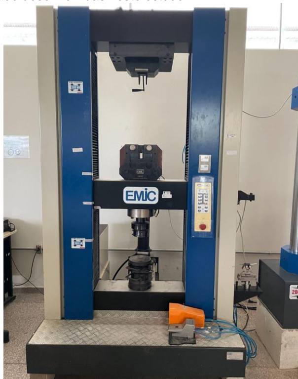
Figura 52 - Máquina universal de ensaios utilizada para romper as peças de concreto de cimento álcali-ativado desenvolvidas neste estudo.
