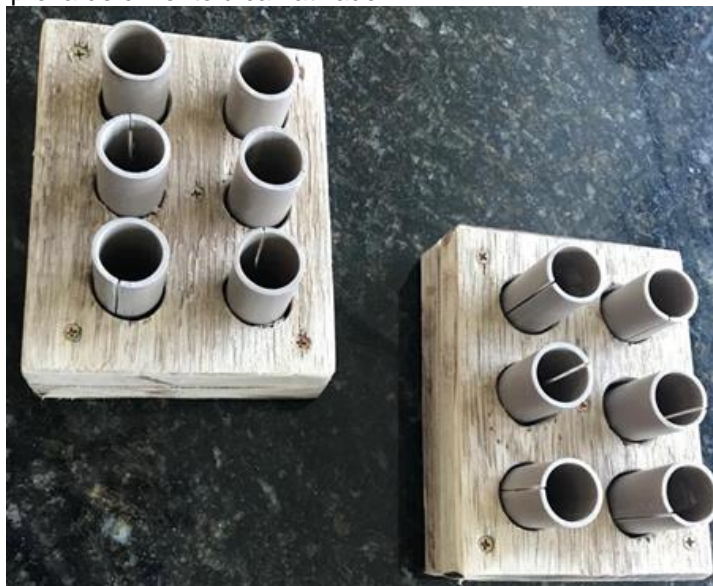
Figura 8 - Moldes cilíndricos de PVC com suporte de madeira utilizados para confecção dos corpos de prova de cimento álcali-ativado.
