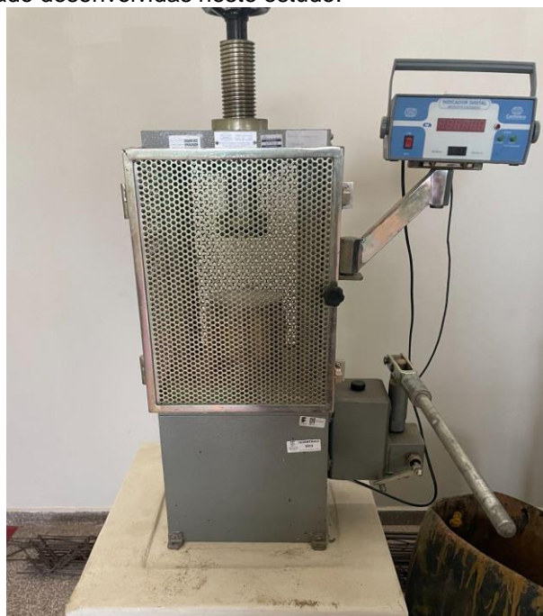
Figura 51 - Máquina universal de ensaios utilizada para romper as peças de concreto de cimento álcali-ativado desenvolvidas neste estudo.
