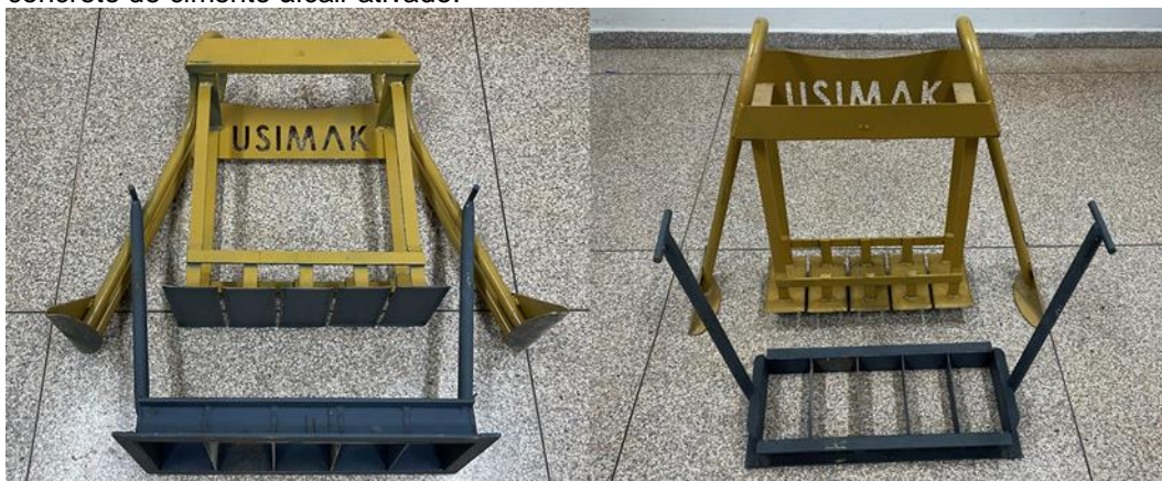
Figura 35 - Detalhe do equipamento da Usimak utilizado para moldagem das peças de concreto de cimento álcali-ativado.
